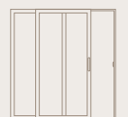
Sliding Patio Door
